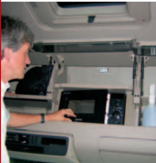
**Aus dem Sonderausstattungsprogramm stammt der Kucheneinbau mit Mikrowelle über der Windschutzscheibe.**
