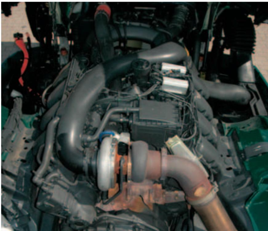
Das mächtige V8-Triebwerk leistet 620 PS und gibt ein maximales Drehmoment von 3.000 Nm ab.
