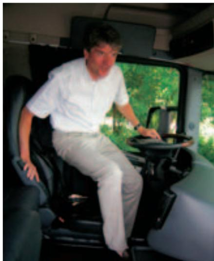
**Der Überstieg auf dem Motortunnel gelingt dank Sitzabsenkung und hochklappbarem Lenkrad ohne Verrenkungen.**
