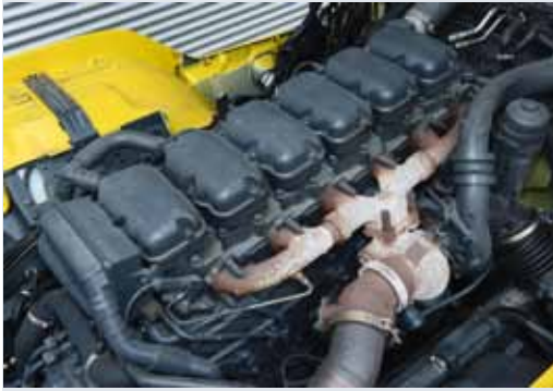
Powerplay: der 6-Zylinder-Reiheindiesel DC13 (links) gegen das V8-Dieselmotorwerk DC16
