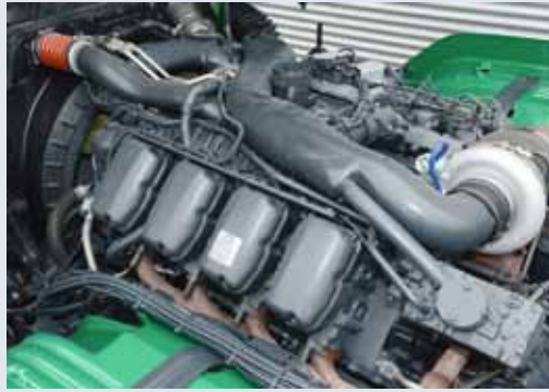
Powerplay: der 6-Zylinder-Reiheindiesel DC13 (links) gegen das V8-Dieselmotorwerk DC16
