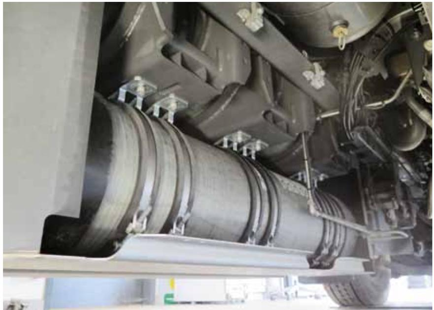
Gut gelöst: Die CNG-Tanks sind geschützt hinter der Seitenverkleidung untergebracht.
