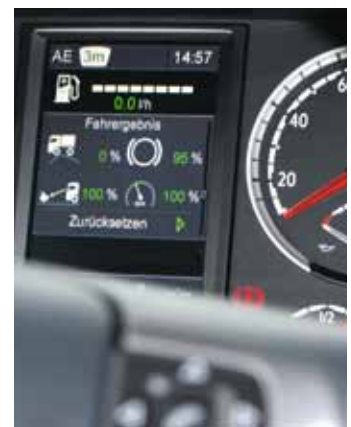
Ehrgeiz wecken: Das serienmäßige Scania-Eco-Modul ist ein System, das über das Display im Kombiinstrument dem Fahrer Rückmeldungen bezüglich des Kraftstoffverbrauchs liefert und beurteilt, wie vorausschauend der Fahrer unterwegs ist.
