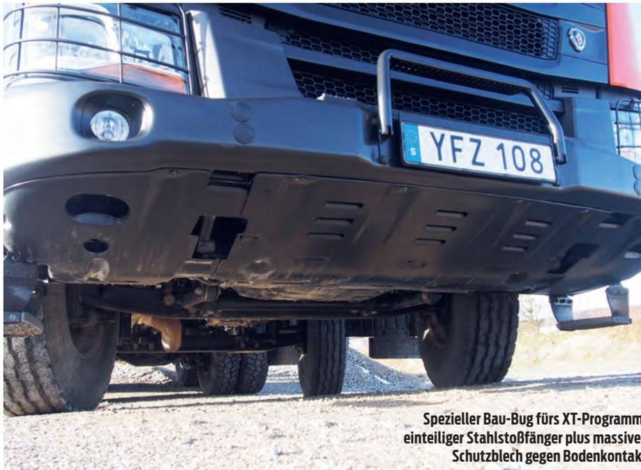
Spezieller Bau-Bug fürs XT-Programm: einteiliger Stahlstoßfänger plus massives Schutzblech gegen Bodenkontakt
