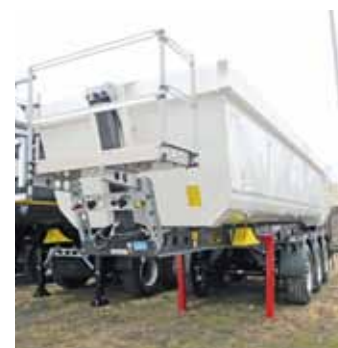
Light-Stahlmulde mit Light-Chassis: unter 5 t Leergewicht
