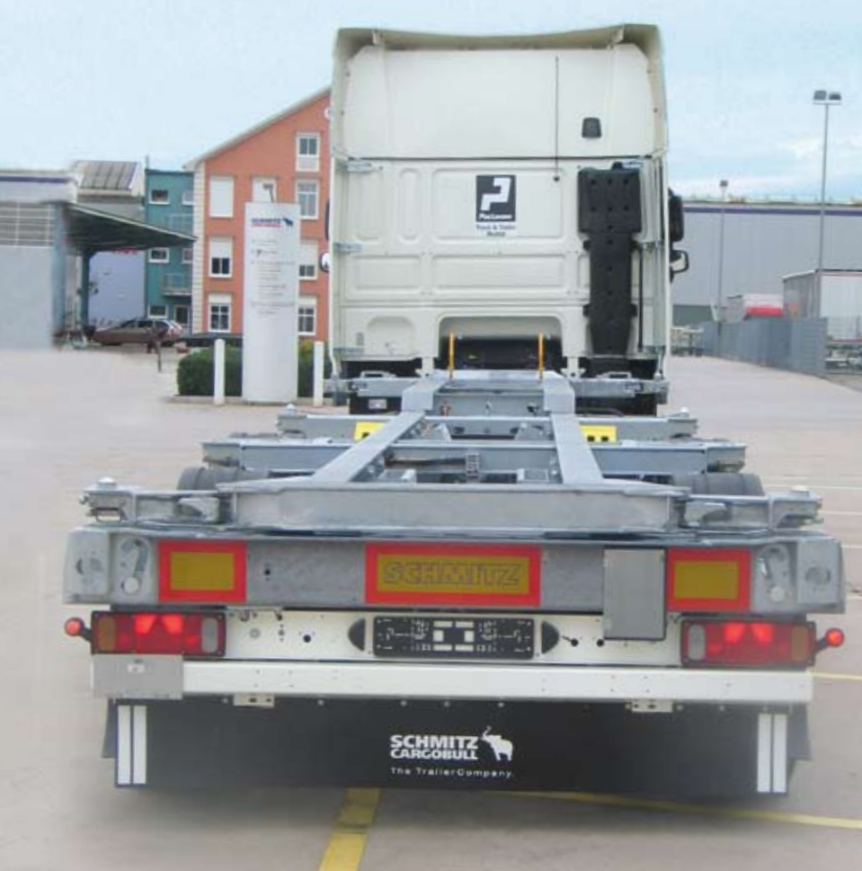
Sliding Bogie, Containerchassis. Oben: Stellung 20 ft. und 40 ft. ohne Tunnel. Unten: Vorderer Tragarm
