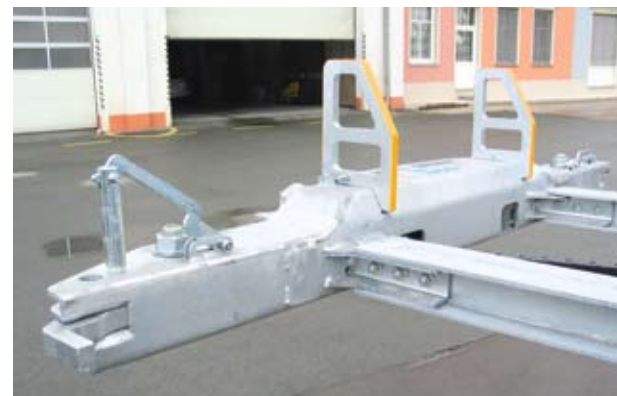
Sliding Bogie, Containerchassis. Oben: Stellung 20 ft. und 40 ft. ohne Tunnel. Unten: Vorderer Tragarm
