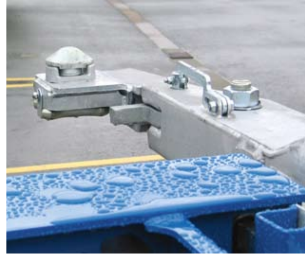
Sliding Bogie, Containerchassis. Oben: Stellung 20 ft. und 40 ft. ohne Tunnel. Unten: Vorderer Tragarm
