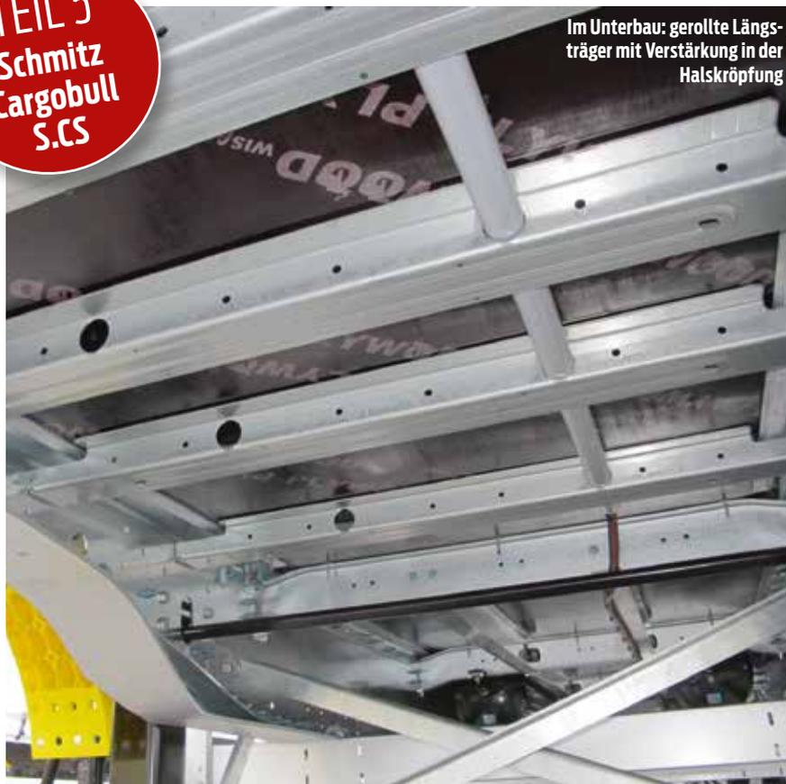
Im Unterbau: gerollte Längsträger mit Verstärkung in der Halskröpfung
