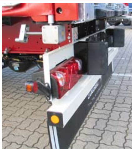
Wanne verstärkt für kleinere Querschnitte; Frankreich-spezifisch: verlängerte Puffer
