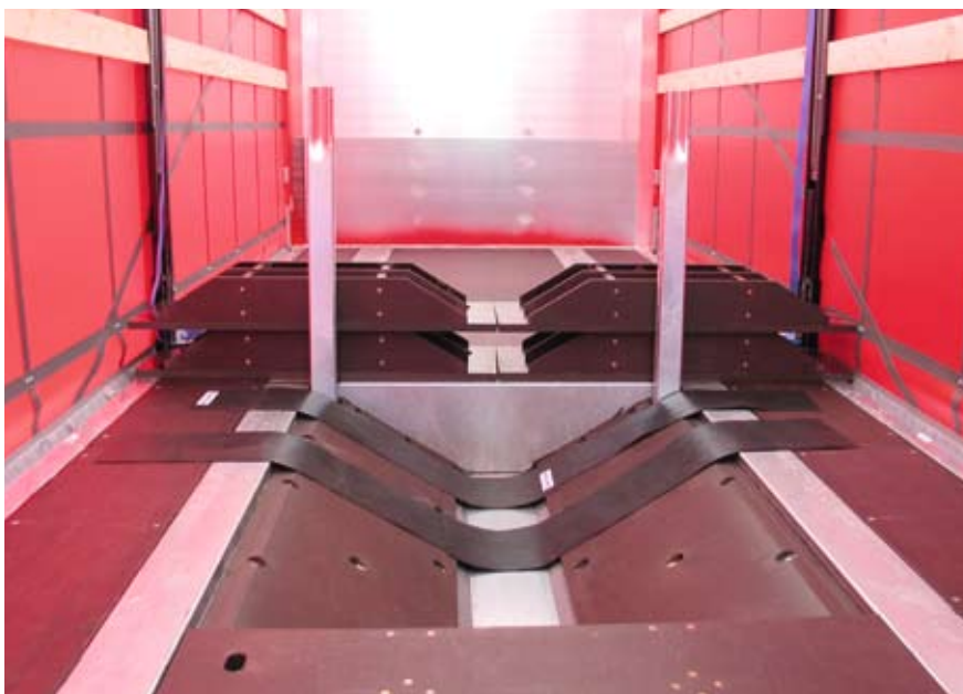
Wanne verstärkt für kleinere Querschnitte; Frankreich-spezifisch: verlängerte Puffer
