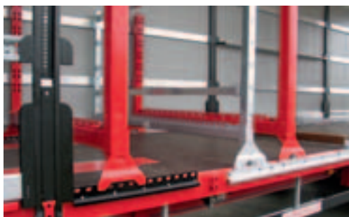
Aus Deurne: Knapen-Schubboden; links oben: Patentierter 40-Millimeter-Hals; links unten: Ladungssicherung für die Pritsche
