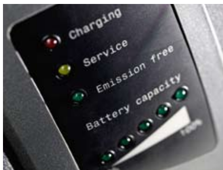
Kontrollleuchten an der Mittelkonsole geben Auskunft über Lade- und Betriebszustände.
