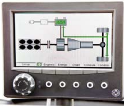
Je nach Fahrzustand des Hybriden wechselt der Energiefluss fortlaufend.
