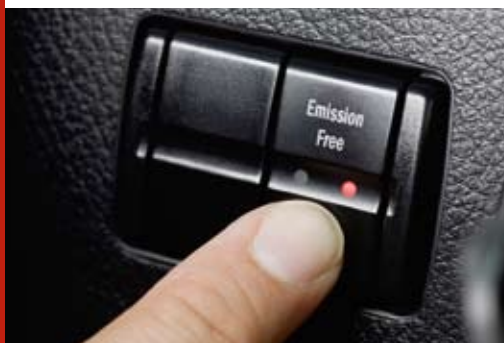
Der Fahrer hat die Wahl: emissionsfreies rein elektrisches Fahren oder gemischter Betrieb im Hybridmodus.
