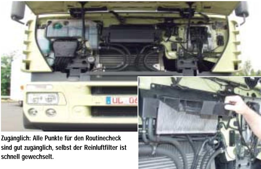
**Zugänglich: Alle Punkte für den Routinecheck sind gut zugänglich, selbst der Reinluftfilter ist schnell gewechselt.**
