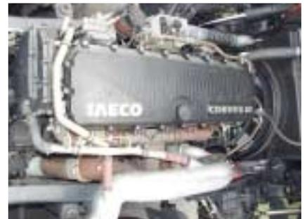
**Kompakt:** Das starke Cursor-Triebwerk mit 10,3 l Hubraum leistet 430 PS und besitzt ein maximales Drehmoment von 1.900 Nm.
