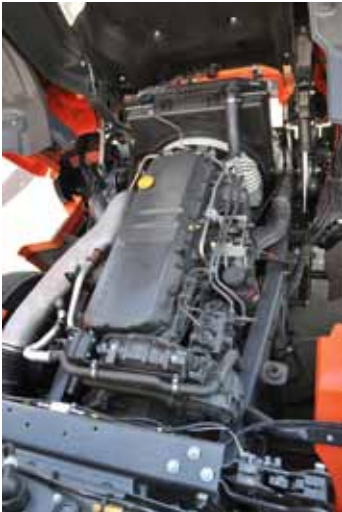
Unter dem Fahrerhaus: Cursor 11 mit Euro 6-Zertifikat Neue Bi-Xenon-Scheinwerfer mit LED-Tagfahrlicht.
