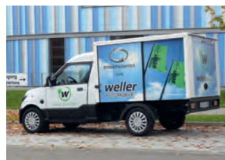
Der GfK-Koffer mit 4,3 m 3 Volumen nimmt auf einem Hochrahmen Platz.
