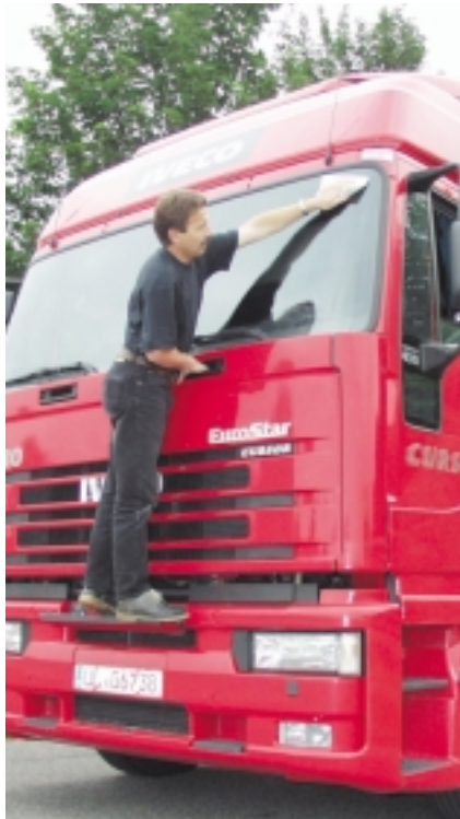
Die Scheibenreinigung lässt sich sicher dank gut platzierter Haltegriffe und ausreichend großem Klapptritt durchführen.
