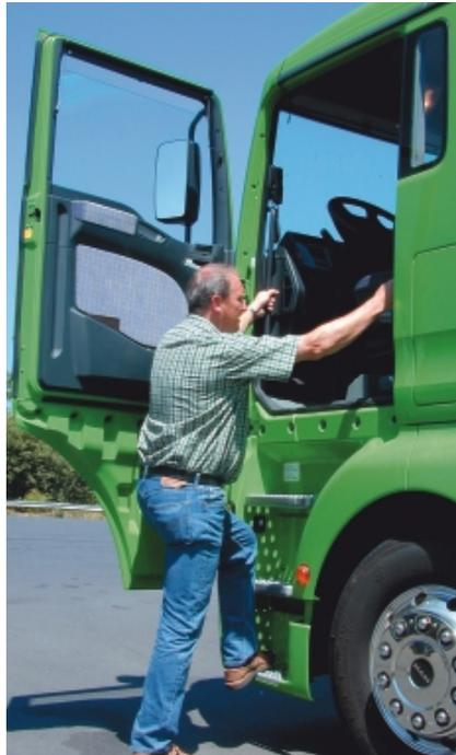
Gut aufgeteilte Trittstufen mit bequemer Tritthöhe führen zum etwa 1,45 m hohen Fahrerhausboden der XL-Kabine.
