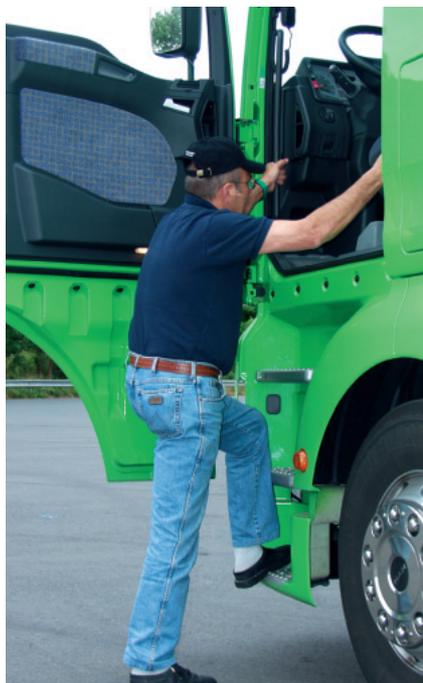
**Der sichere Aufstieg zum praktisch ebenen Kabinenboden erfolgt über günstig aufgeteilte Trittstufen.**
