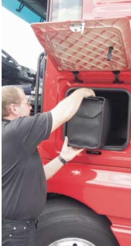
**Praktisch:** Die großen Außenstauflächen sind zur Kabine hin luftdicht abgeschlossen.
