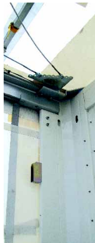
Alles aufgeplant bis zur Paketlänge (oben). Stahl-Stirnwand und Edscha-Drahtseil-Ensemble
