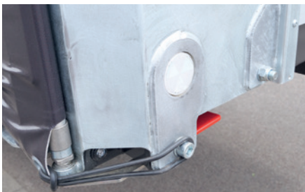
Sinnvoll: die Warn-Reflektoren in den außenliegenden Eckungen
