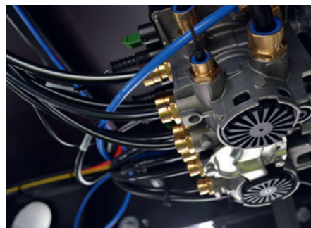
Modulator: Haldex, dritte Generation „EB+“
