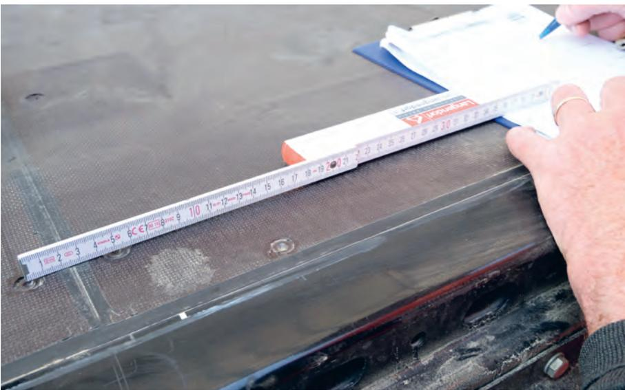
**K-Fix-Ladungssicherungssystem mit 118 Zurrpunkten je Seite (oben); tadellose Bodenkonstruktion mit vollständig versiegelter Verschraubung, die Stöße zwischen den Platten und Rändern sind ordentlich abgedichtet.**
