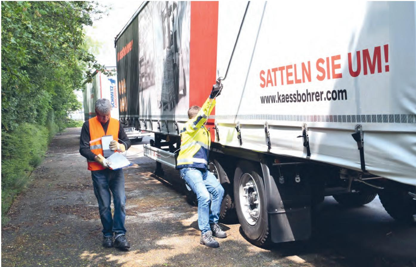
Ein Kraftakt: das Aufziehen des Edscha-Verdecks. Ansonsten kann die Dachkonstruktion punkten.
