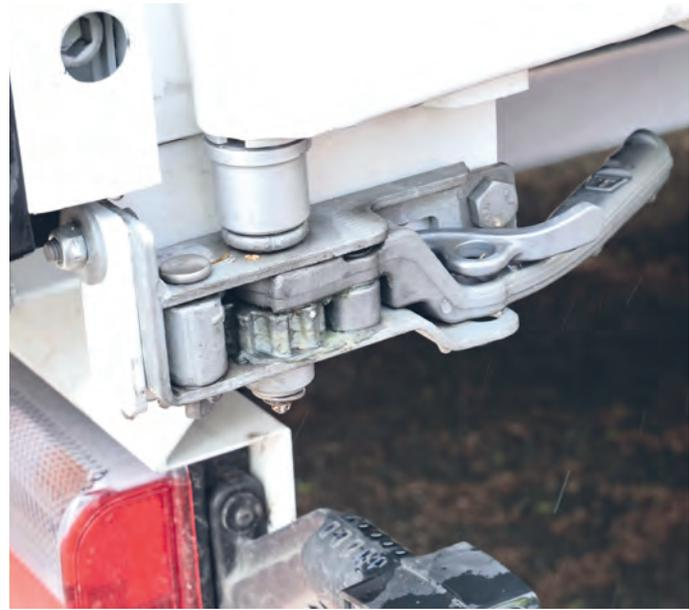
**Überaus gelungen: die einwandfreie Verschlussmechanik der Adaico-Rungen (linkes Bild); leichtgängiges und sauber arbeitendes Zurrgetriebe, allerdings freiliegend**
