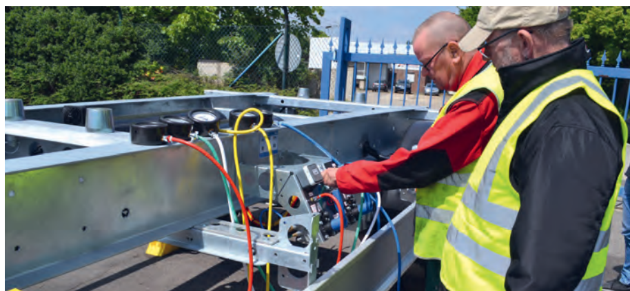
Den Manometern entgeht nichts: das Prüf-Team bei der Hub- und Senkmessung
