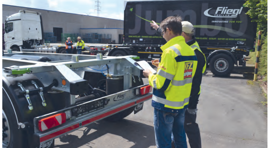
„Richtig gut“: Unterfahrschutz, Einweiser, Gummirammpuffer – das Heck ist tadellos.
