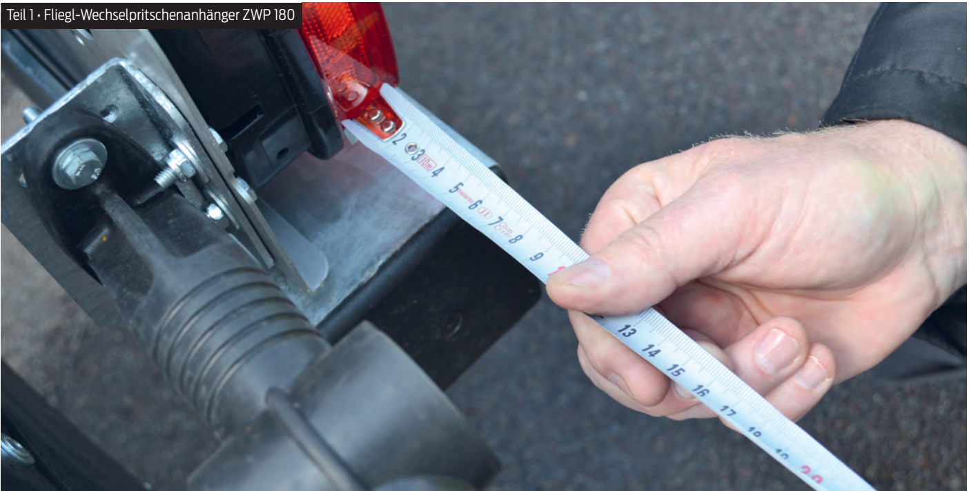
Abstands-Überprüfung zwischen Rückleuchten und Markierungs- leuchten (Außenkante zu Außenkante): „gut gelöst“
