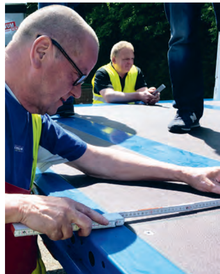
Sauber verarbeiteter Hybrid-Boden, ordentliche Verschraubung; alle Abstände stimmen.
