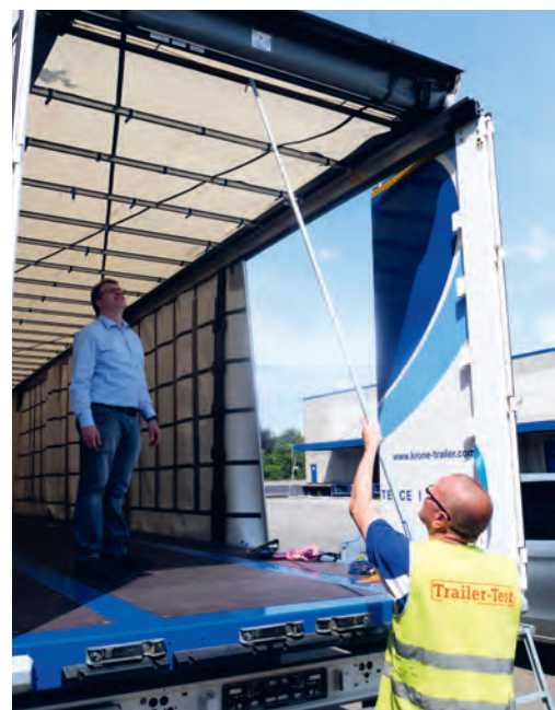
Gutes Handling: das Spanngetriebe an der Wickelwelle (links); sinnvoll positioniert, ausreichend lang: die Zugstange (Mitte); einfaches Lösen des Endlaufbalkens
