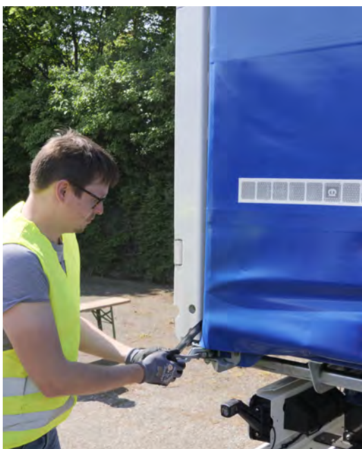
Gutes Handling: das Spanngetriebe an der Wickelwelle (links); sinnvoll positioniert, ausreichend lang: die Zugstange (Mitte); einfaches Lösen des Endlaufbalkens
