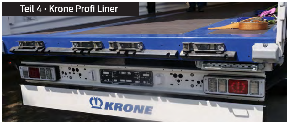
Überzeugendes Heck: innovative LED-Beleuchtungsanlage; gut durchdachter Rammschutz
