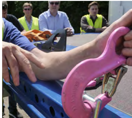
Ladungssicherung: Dank Multi-Lash-Zurringen können auch große Kettenhaken verwendet werden.
