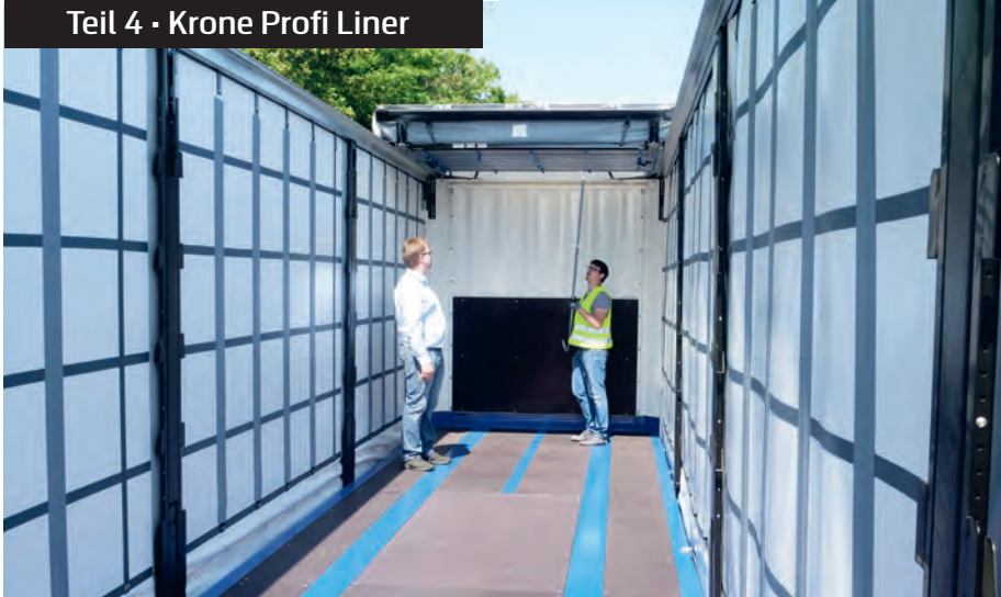
Blick ins Innere: Profi Liner mit geöffneter Dachplane; die Paketverriegelung überzeugt.
