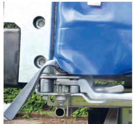
Pluspunkt: Die Wickelwelle des S.CS verfügt über eine Zugschleife. Das erleichtert das Aus- und Einsetzen der Welle erheblich. Das Thiriet-Zurrgetriebe läuft tadellos.
