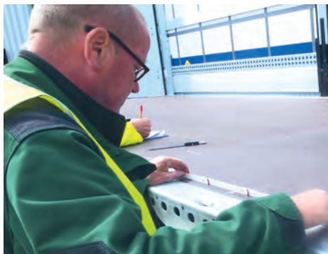
Prüfung bestanden: der sauber verarbeitete Plywood-Boden des S.CS, die Verschraubung ist ohne Mängel
