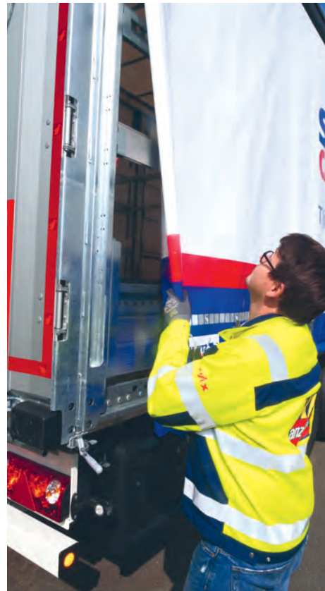
Pluspunkt: Die Wickelwelle des S.CS verfügt über eine Zugschleife. Das erleichtert das Aus- und Einsetzen der Welle erheblich. Das Thiriet-Zurrgetriebe läuft tadellos.
