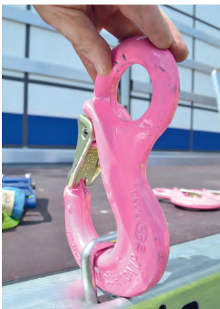
Groß, größer, U-Bügel: hier passen auch Kettenhaken der RUD-Größe 73 durch
