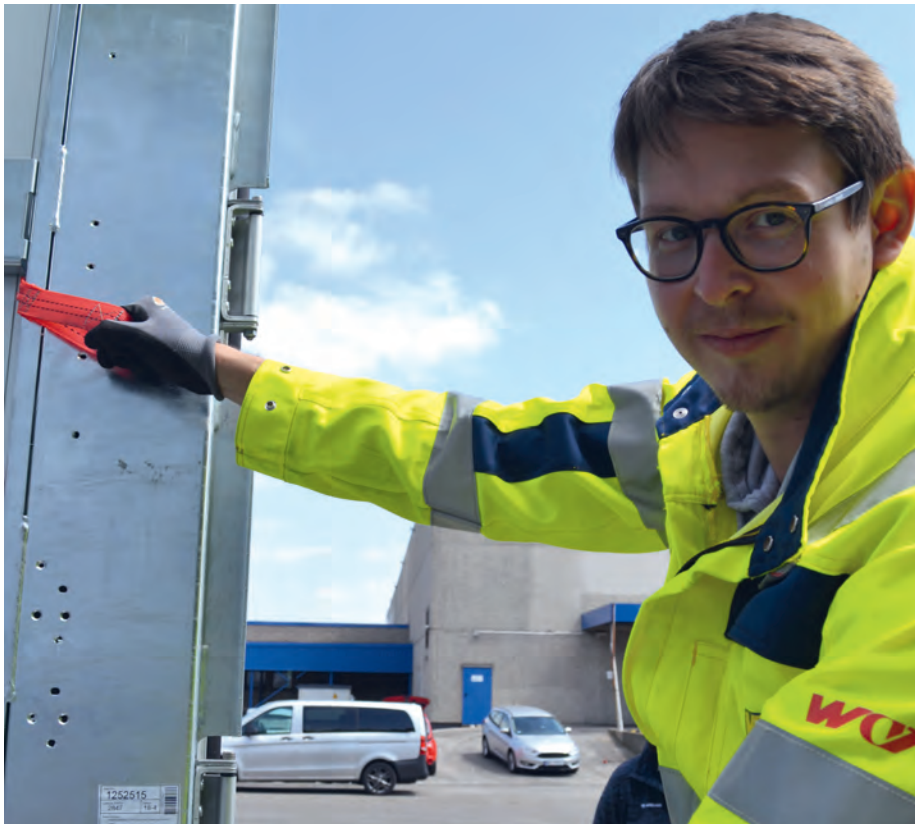
Nützlich: der Haltegriff am Trailer-Heck. Er erleichtert den Aufstieg auf die Ladefläche.
