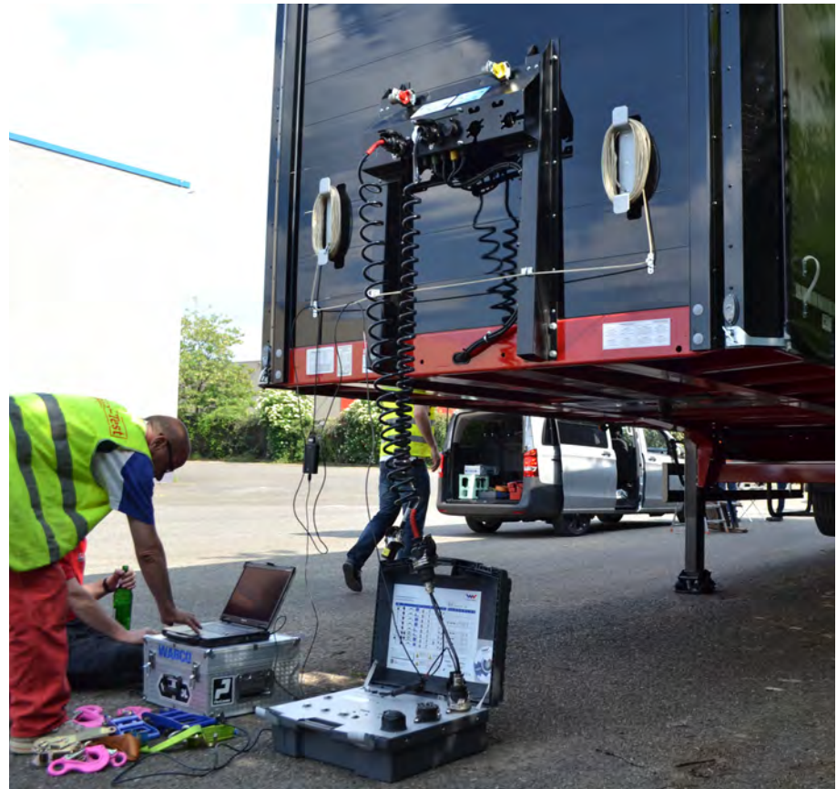
Keine Fehler erkannt: das Auslesen der EBS-Anlage
