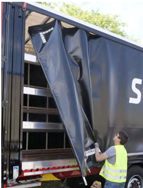
Wichtiger Prüfpunkt: das Öffnen der Plane samt Messung der Aufzugkraft
