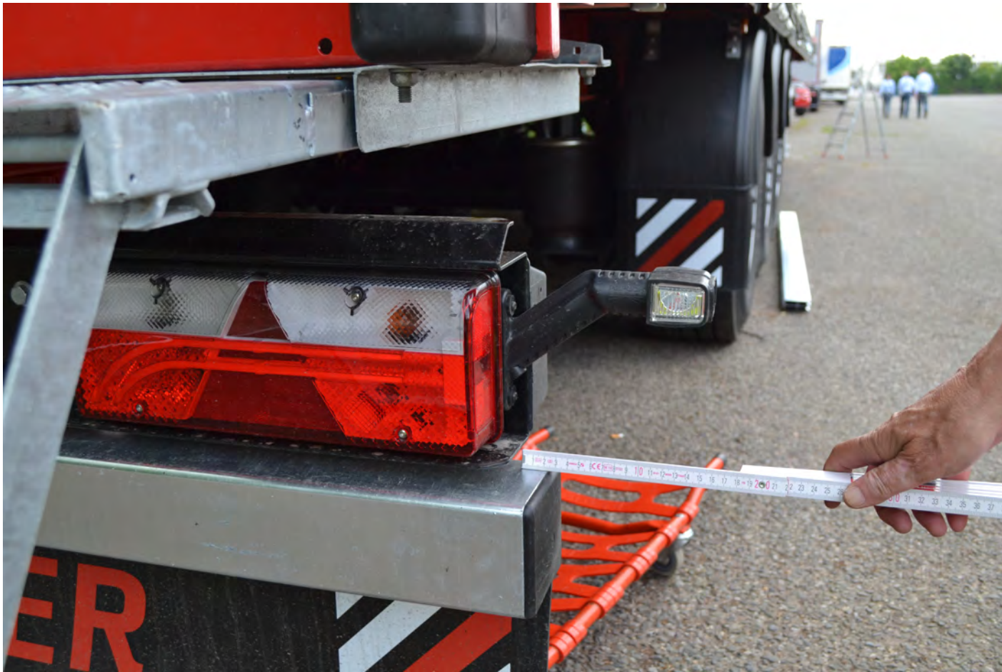
Vorbildlich: die gut geschützte Beleuchtungsanlage am Trailer-Heck
