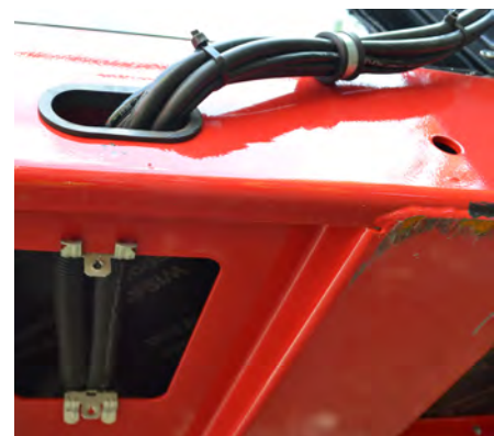
Vor Schäden an der Rampe geschützt: Heckabschluss mit Gummipuffer (oben); Durchleitung in den Rahmen (unten);
