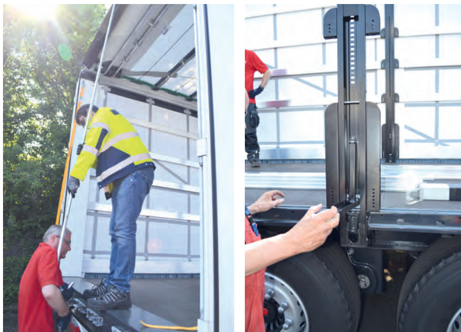
Öffnen des Endlaufbalkens: „sehr einfach“ (links unten); auch die Rungen öffnen leichtgängig (rechts); innovative Ladungssicherung: mit dem optional erhältlichen Adapter für RUD-Kettenhaken bis Größe 10.
