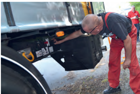
Vorbildlich: der Heckabschluss des Curtain Master (oben), gut geschützt mit stabilen Gummiramppuffern (rechts); Blick unter den Trailer: die Bedienelemente sind leicht zugänglich.
