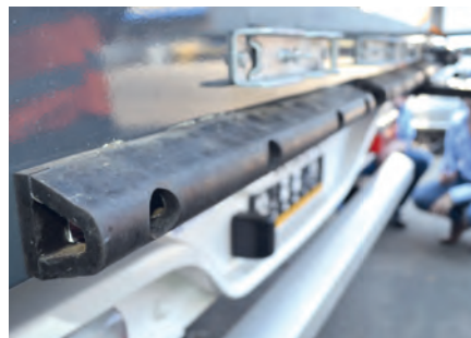
Vorbildlich: der Heckabschluss des Curtain Master (oben), gut geschützt mit stabilen Gummiramppuffern (rechts); Blick unter den Trailer: die Bedienelemente sind leicht zugänglich.
