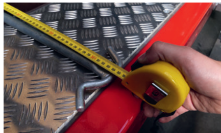
Sinnvolle Ausstattung: Ladungssicherungssystem mit Sperrbalken für die Teilbeladung (links); teleskopierbare Zugstange
