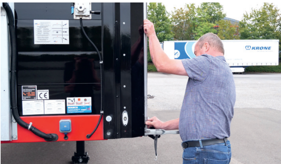
Bietet ein einfaches Handling: das vordere Planenrohr mit Hebeschlaufe und Spannratsche
