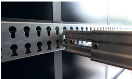
Sinnvolle Ausstattung: Ladungssicherungssystem mit Sperrbalken für die Teilbeladung (links); teleskopierbare Zugstange
