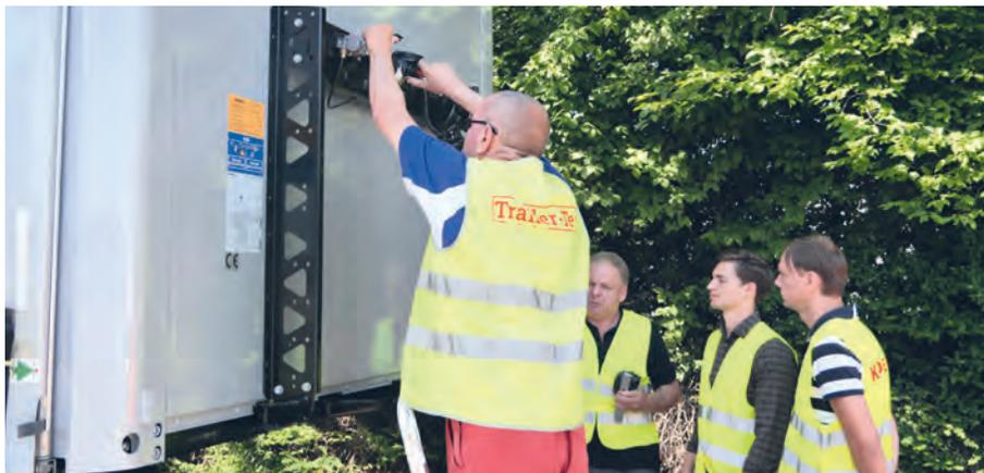
**Kögel-Stirnwandtraverse: gute Kabelführung; allerdings zu geringer Abstand zwischen den Anschlüssen.**
