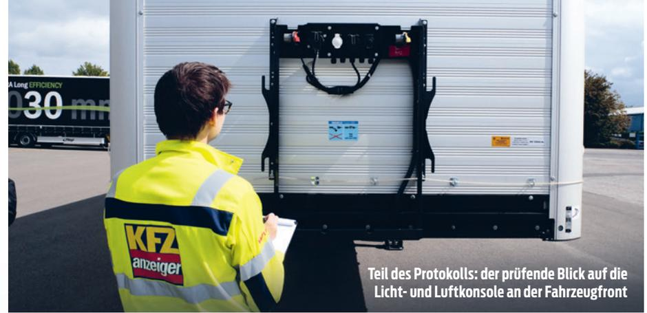
Teil des Protokolls: der prüfende Blick auf die Licht- und Luftkonsole an der Fahrzeugfront
