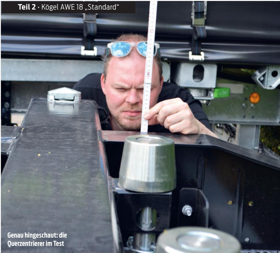
Genau hingeschaut: die Querzentrierer im Test
