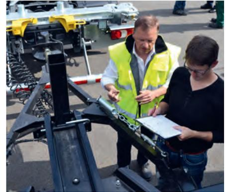
Praktisch: die einfache und schnelle Höhenverstellung der Zugdeichsel über den Federmechanismus
