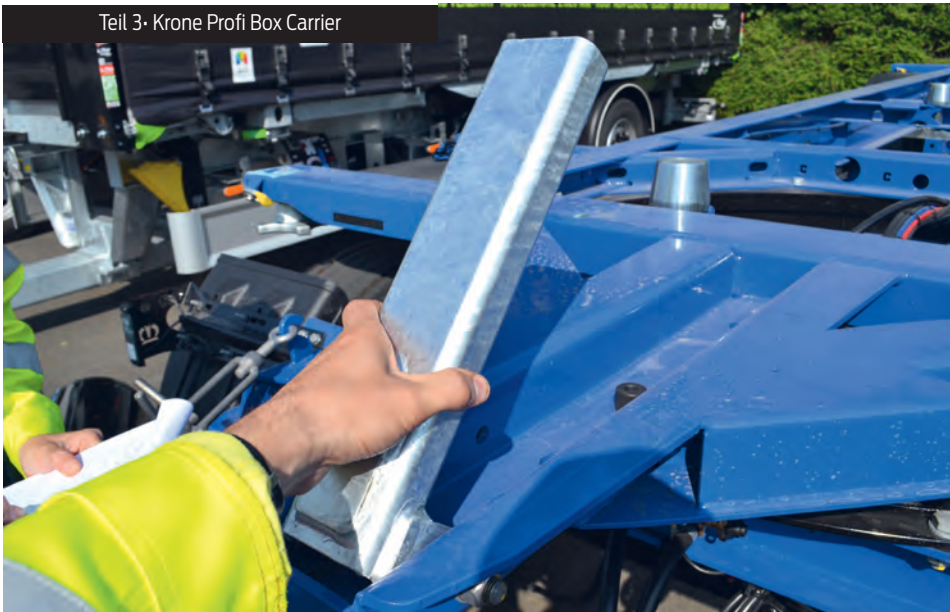
Praktisch: der klappbare Längsanschlag; nützlich: Twistlocks mit Fallsicherung (Mitte)
