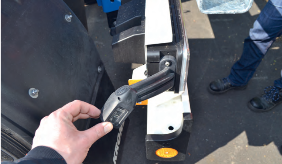
Frei schwingend, aus hochelastischem Gummi: eine der beiden Positionsleuchten am Fahrzeugheck
