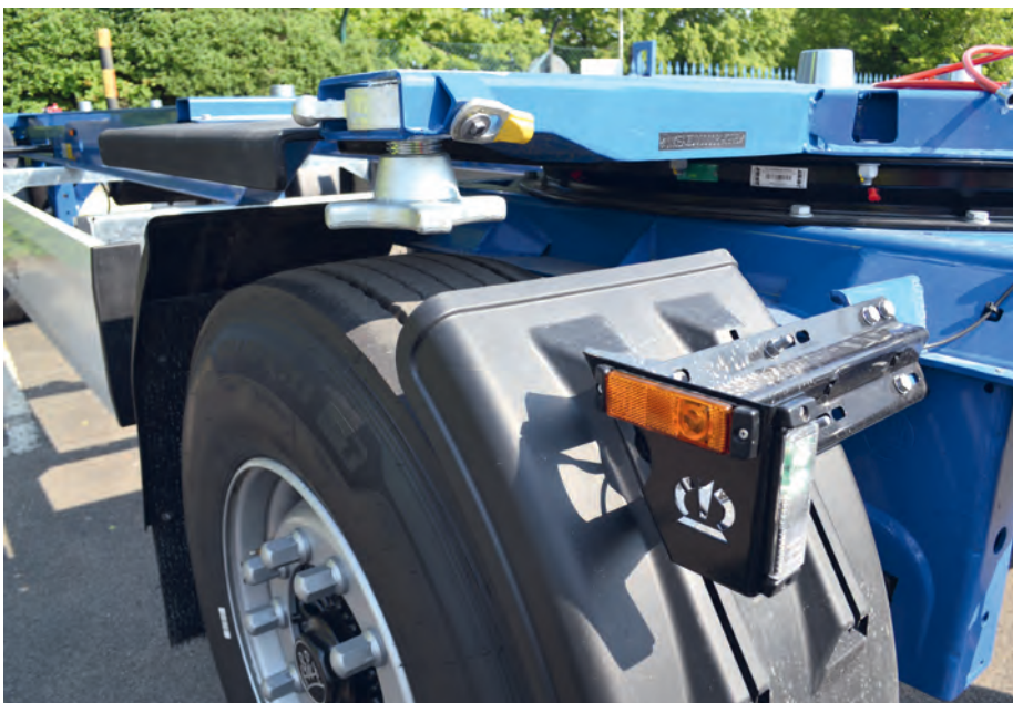
Die Kotflügel kommen ohne klassisches Rundrohr, die Halterung ist fest mit dem Chassis verschraubt.
