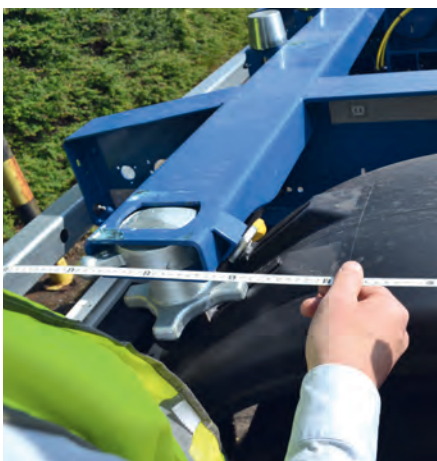
Praktisch: der klappbare Längsanschlag; nützlich: Twistlocks mit Fallsicherung (Mitte)
