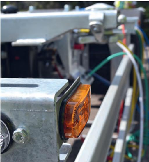
**Kleiner Wermutstropfen: Die Seitenmarkierungsleuchten ragen an einigen Stellen zu weit aus dem Rahmen heraus.**
