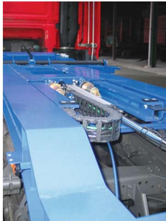
**Oben: knapper Raum für die Verbindungsleitungen. Unten: vorderer Ausschub mit Energiekette**
