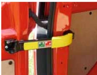
Sicherer Halt für die Hecktüren in 90-Grad-Position, Erweiterung mit einem schnellen sicheren Griff.
