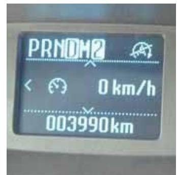
Das Display zwischen den Armaturen informiert über den aktuellen Modus. Bei manuellen Eingriffen zeigt es ebenfalls die gewählte Schaltstufe an.
