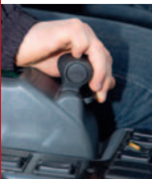
Im Wendemodus EQR kann der Fahrer über die Schaltwippe direkt vom Vorwärtsgang den Rückwärtsgang auswählen und umkehrt.
