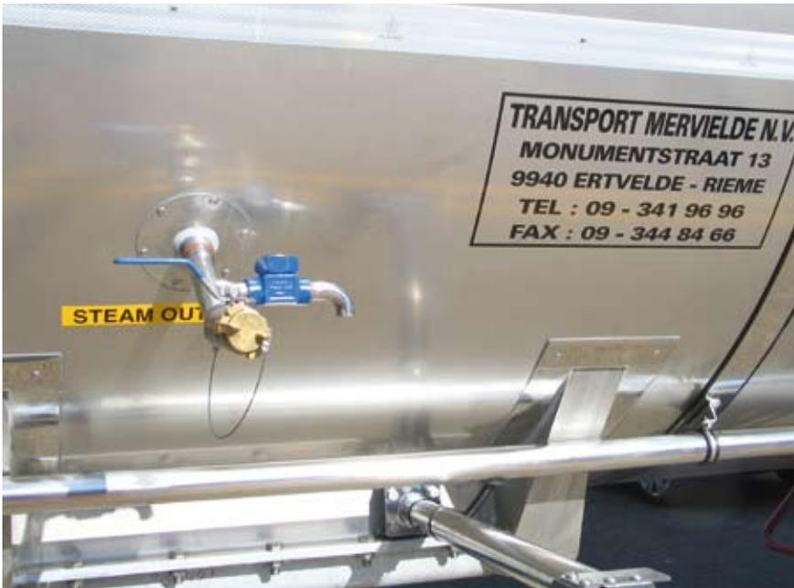
**Präzision: Dampfheizung, Entwässerungsseite**
