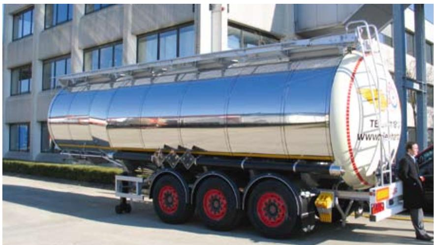
**Bild oben: Kundenwunsch Leuchtenzeile oben. Vorteil kurz: Gooseneck-Kesselkonstruktion**
