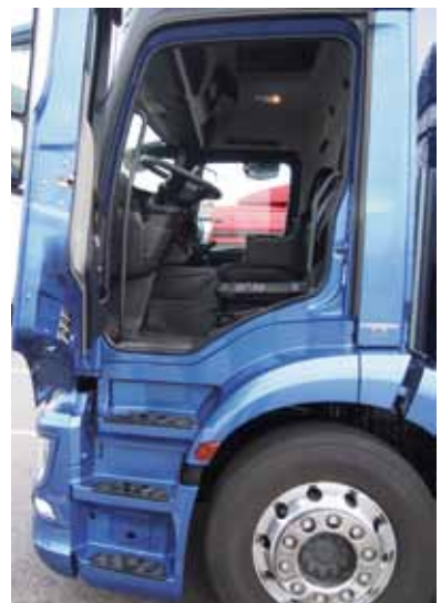
Einstieg Antos: eine Stufe mehr mehr als beim Atego (darunter), aber treppenförmig
