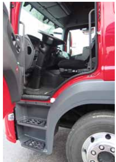
Einstieg Antos: eine Stufe mehr mehr als beim Atego (darunter), aber treppenförmig
