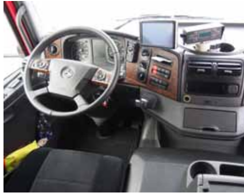
Neue Instrumente und neues Funktionslenkrad für den Atego, der hohe Motortunnel behindert den Durchstieg.
