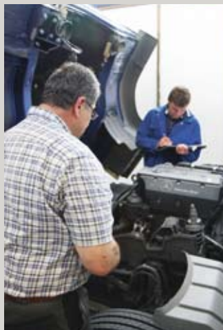
Auffällig positiv – der Luftfilter des Atego lässt sich bei gekipptem Fahrerhaus ohne Werkzeug wechseln.
