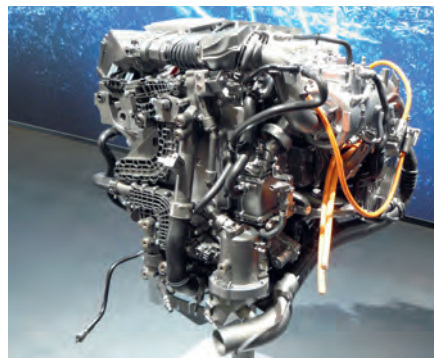
Das Package der Brennstoffzelle erinnert an einen Verbrennungsmotor und passt deshalb unter die Motorhaube.
