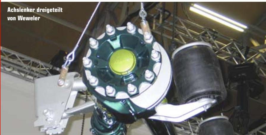
**Für Bremscheiben und -zangen** sorgt Wabco. Die Zuspansseinheiten (PAN 19-1 und 22-1) sind zwar nicht die ganz neuen NG22MAX (die mit der optionalen kontinuierlichen Belagverschleiß-Messung), aber die einfache Ein-Stempel-Technik ohne Zahnräder oder Kette und mit nur sieben kleinteiligen Sonderwerkzeugen für das Ein- und Auspressen der Gleitlager kann auch in Ländern ohne hauseigenes Servicenetzwerk die Bedenken gegen die Scheibenbremse mildern.
