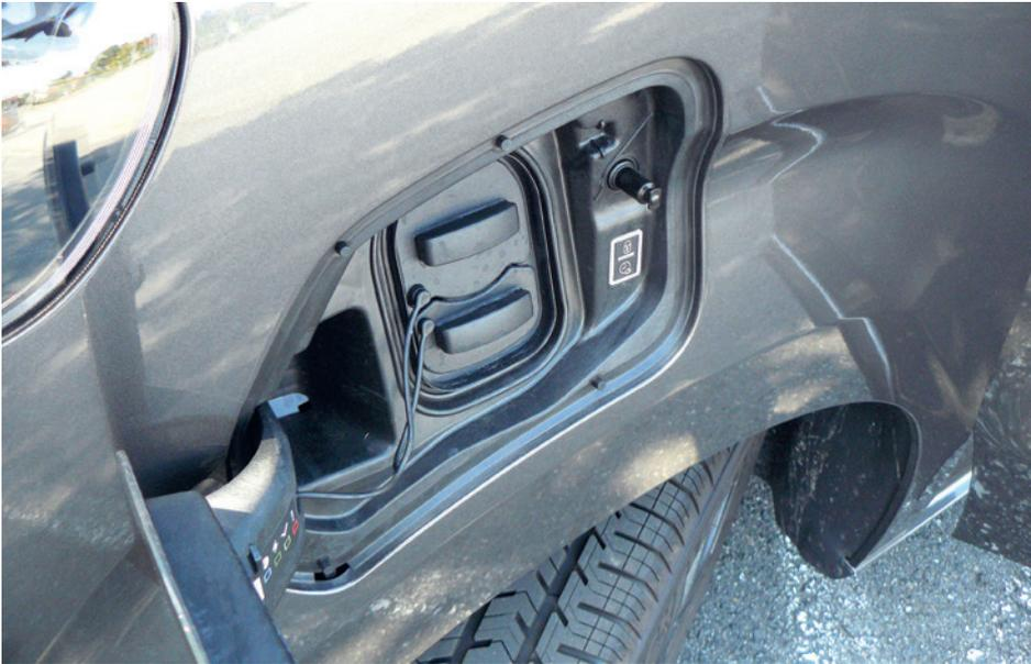
Strom wird vorne links eingeflößt, schnelles Laden klappt bis 100 kW.
