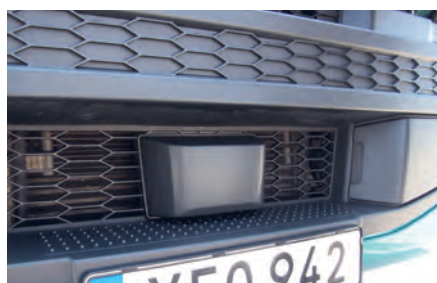
Der Notbremsassistent ist Pflicht: Bei Volvo detektieren ein Radar- und ein Kamerasystem gemeinsam die Fahrbahn.
