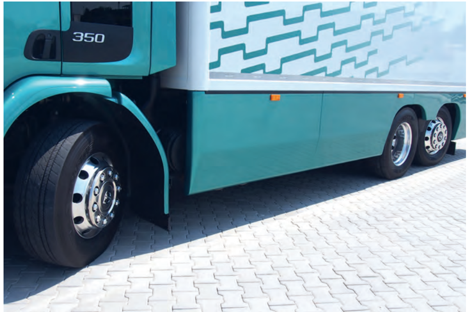
Zwei Lenkachsen für den Nahverkehr: Der Volvo-Dreiachser packt mit 17,7 m Wendekreis fast jede Biegung.
