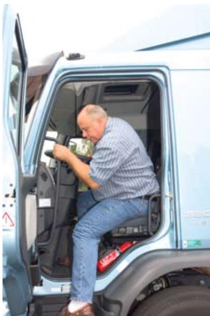
**Sitzschnellabsenkung und hochklappbares Lenkrad für eine günstige Einstiegssituation.**
