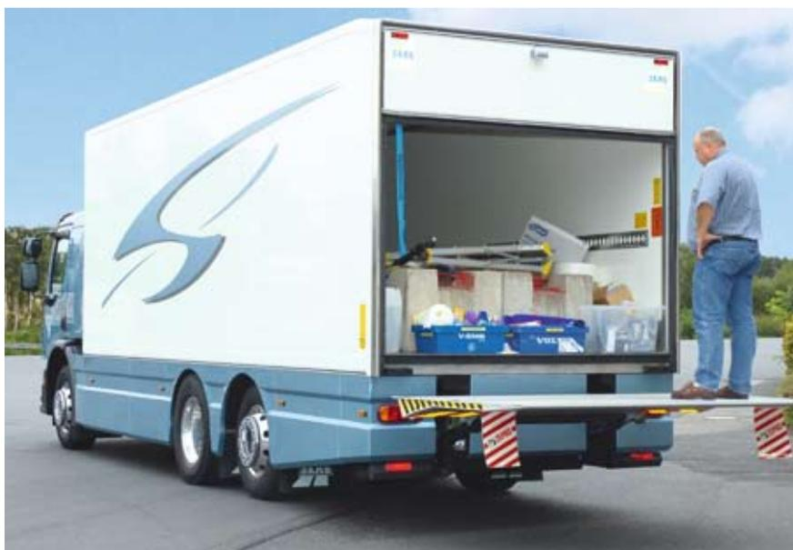
**Der FE 6x2 mit Kofferaufbau und Ladebühne kann als 26-Tonner rund 15,2 t zuladen.**
