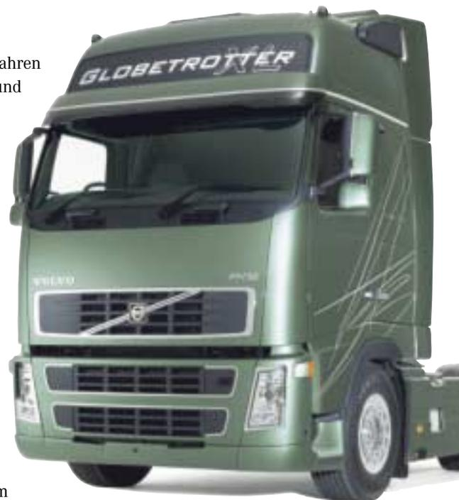
Brake (VEB) lässt sich die Motorbremsleistung auf insgesamt 517 PS steigern. Hier kann schon von Retarder-Qualität gesprochen werden. Da muss bei Gefällefahrten auch mit 60 t Zuggesamtgewicht die Betriebsbremse kaum noch zum Einsatz kommen.
