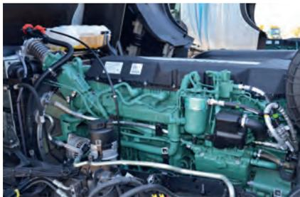
**LNG-Betankung (oben); modifiziertes Volvo-Triebwerk (Otto-Motor) mit Diesel-betriebener Fremdzündung**
