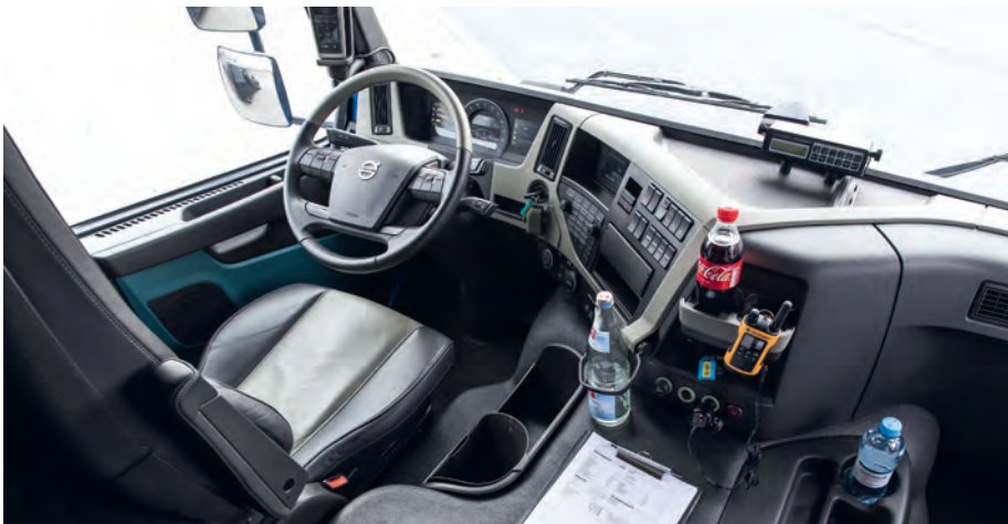
Mehr Raum in der FH-Kabine: nur ein marginaler Motortunnel, die Liege ist breiter und bequemer. Mit dem fahrerorientierte Armaturenräger wird Platz verschenkt. Oben: Engere Verhältnisse im FM-Fahrerhaus: Prima Ergonomie und zeitgemäße Bedienung, aber kurzer Sitzabstand zum Lenkrad.
