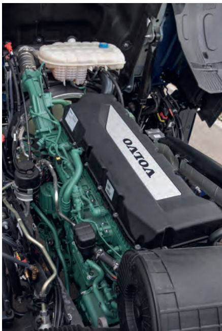
Leichte Kavallerie: Der stärkste D11K-Sechszylinder mobilisiert aus 10.8 Liter Hubraum 450 PS und bis zu 2.150 Newtonmeter.
