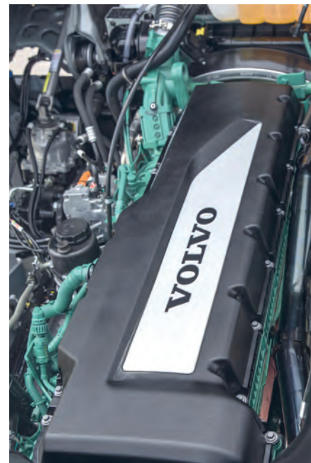
Viel Dampf aus dem Drehzahlkeller: Der D13K-Sechszylinder liefert schon ab 800 Touren verwertbare Leistung.
