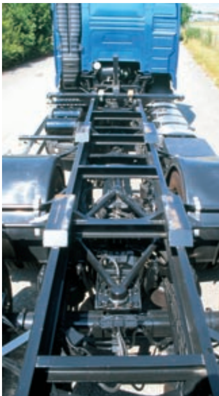
Stabiles Rückgrat für technisch zulässige 27 t, beide Hinterachsen verfügen zusammen über acht Luftfederbälge.
