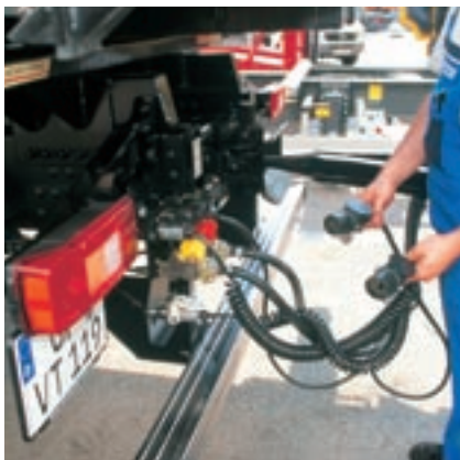
Eine Frage der richtigen Anschlüsse: Bei den siebenpoligen Strom-Anschlüssen hilft nur noch das richtige Adapter-Kabel.
