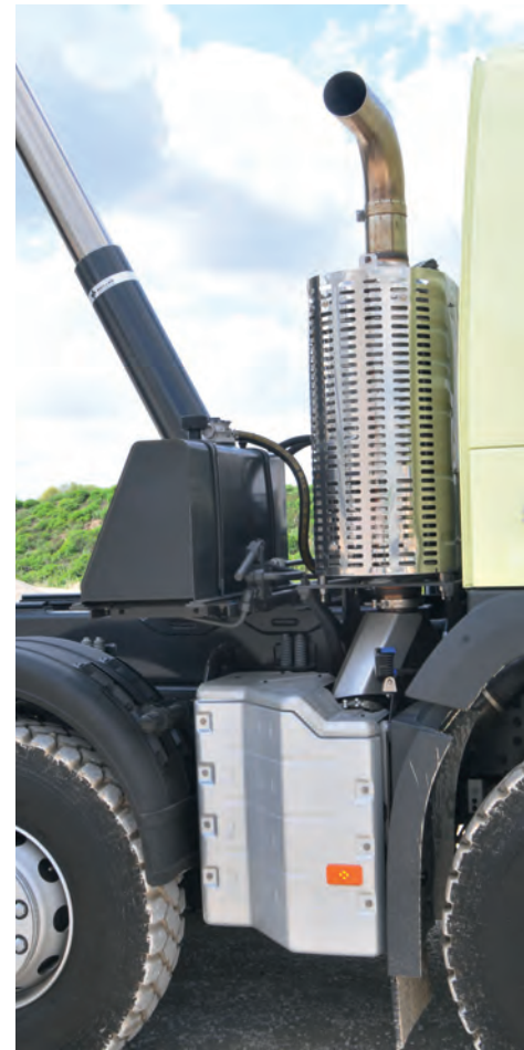
Von links: Hydropneumatisch gefederte Terberg-Nachlaufachse. Trapezfedern erlauben großzügige Verschränkung und übernehmen mit Reibung zwischen den Federblättern die Arbeit von Stoßdämpfern. Kompakte Abgasanlage mit stehendem Schalldämpfer und Endrohr.
