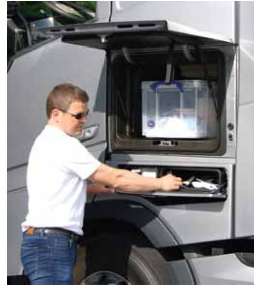
Praktische Anordnung: Großstaufächer oben und geruchdichtes Utensilienfach mit Handwaschwassertank unten
